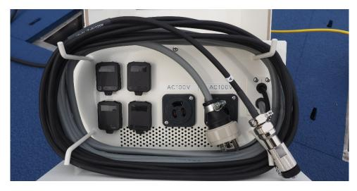
黒の光ファイバーケーブルを HH 奥左側にあるコンセントへと繋ぎます。 また、この HH 内のコンセントには光が流れているので、絶対に覗き込まないこと! 灰色の AC ケーブルは、左の HH にあるコンセントに繋ぎます。
